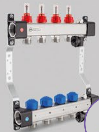
Razdjelnici s mjeracima protoka 2,5 l/min ili 5 l/min (max) i servomotor ventilima te odzračnicima – UFST ili UFST max serija
